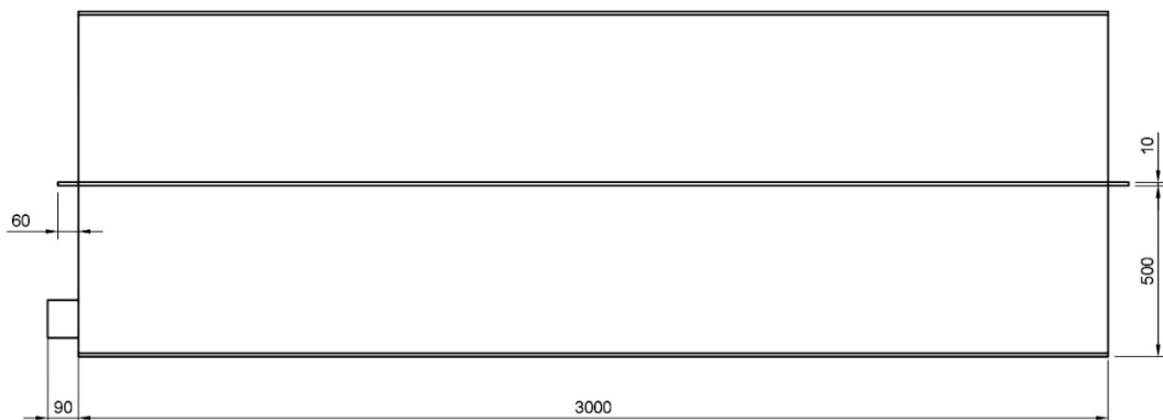
Rys. 7.1. Rzut z przodu stacji uzdatniania wody modelowego systemu recyrkulacyjnego do przetrzymywania tarlaków okonia i przeprowadzania rozrodu pozasezonowego.
