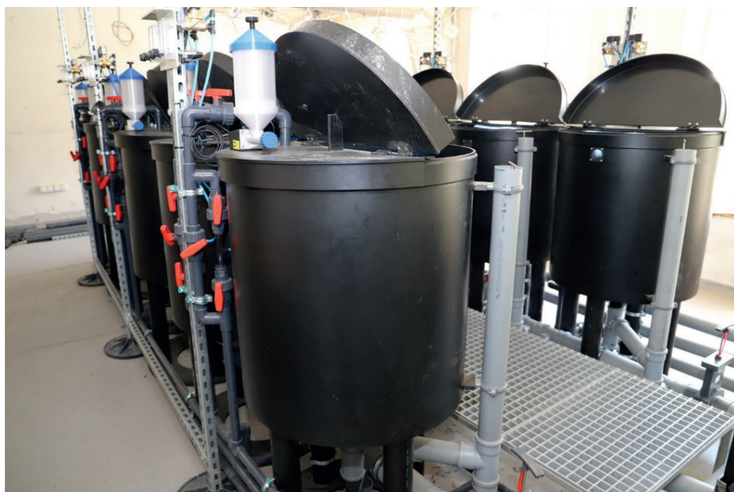
Rys. 7.19. Modelowy system recyrkulacyjny do inkubacji ikry i podchowu larw.
