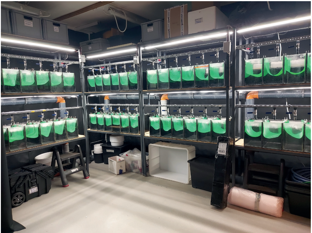
Fot. 4.4. Eksperymentalny system recyrkulacyjny do podchowu larw okonia z czarnymi zbiornikami, górnym dopływem wody do każdego zbiornika i źródłem światła nad powierzchnią wody. Na zdjęciu w zbiornikach są widoczne zamontowane zielone siatki z tworzywa sztucznego, na których inkubowane są porcje ikry.
