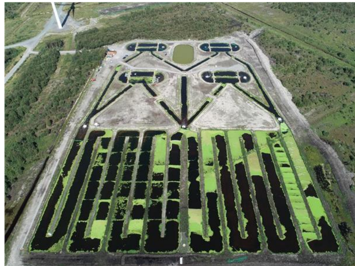
Farma okonia oparta o stawy typu „pill pond” oraz sekcję oczyszczania wody w postaci kanałów służących do produkcji rżęsy wodnej (foto: Damien Toner).
